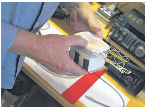
So sieht eine Sonde aus der Nähe aus: Rechts die GPS-Antenne, links der Temperaturfühler und der Luftfeuchtigkeitssensor.
